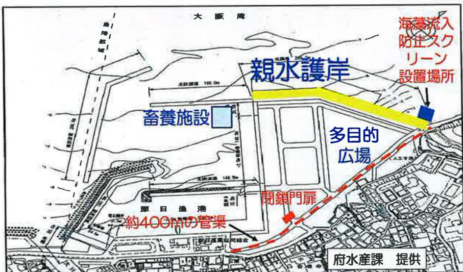
深日漁港の排水函渠(はいすいかんきょ)について伺う。深日漁港には、平成19年に排水函渠が設置されたが、ゴミや海藻などが堆積、腐敗で悪臭が発生。その防止対策として、海藻などの流入を防止するスクリーンを、函渠排出口に設置、大雨時にゴミが付着して排水機能が低下し、平成21年と22年に近隣に床下浸水が発生。その後、函渠内の堆積物の定期的な除去や、スクリーンの開放などの対策により、悪臭や大雨時の浸水は軽減が図られているようであるが、近年の異常気象による豪雨など、浸水害に対する住民の不安感是非常に高く、我が会派には、さらなる改善を求める声が届いている。排水函渠の適正な維持管理は、府の責務、どのように取り組むのか。
